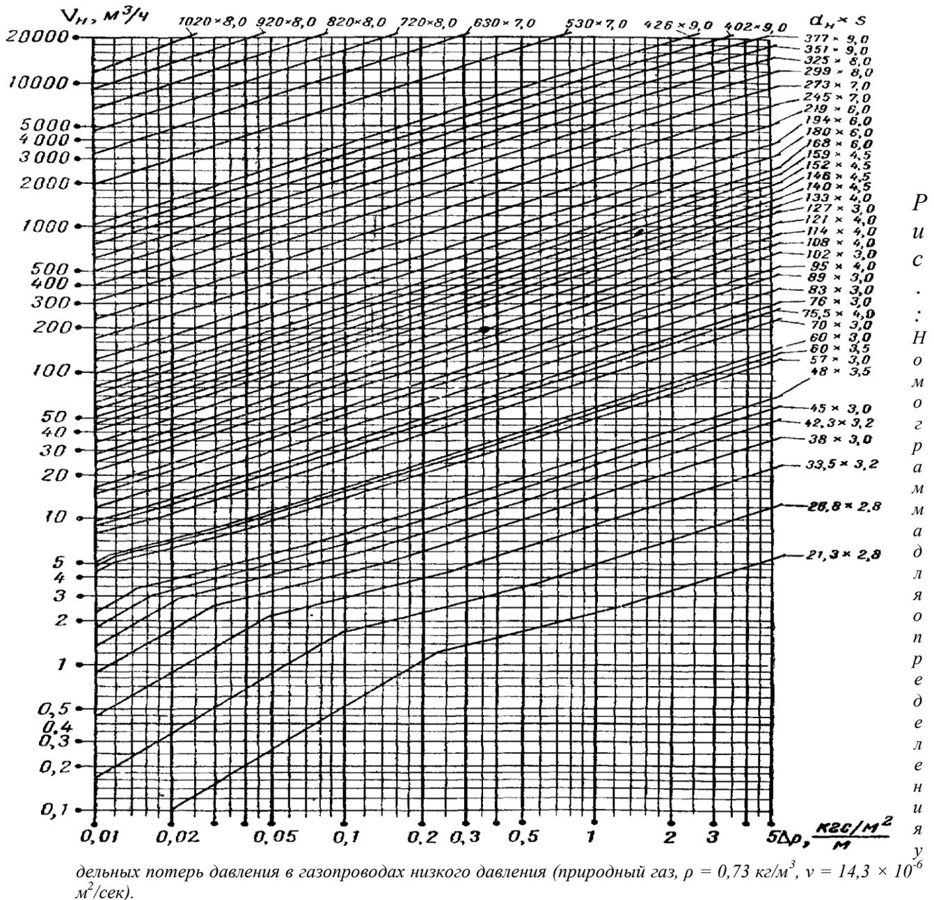
В связи с тем, что указанные номограммы составлены для расчета стальных газопроводов, полученные значения диаметров, вследствие более низкого коэффициента, шероховатости полиэтиленовых труб, следует уменьшать на 5-10%.
